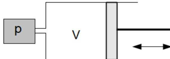
Halbiert man das Volumen eines abgeschlossenen Gasvolumens, so verdoppelt sich der Druck. Halbiert man den Druck, so verdoppelt sich das Volumen.
