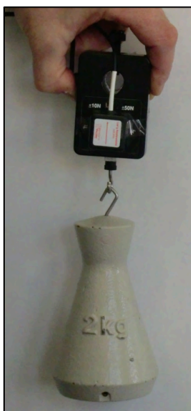
Versuch mit Kraft- und Beschleunigungssensor
