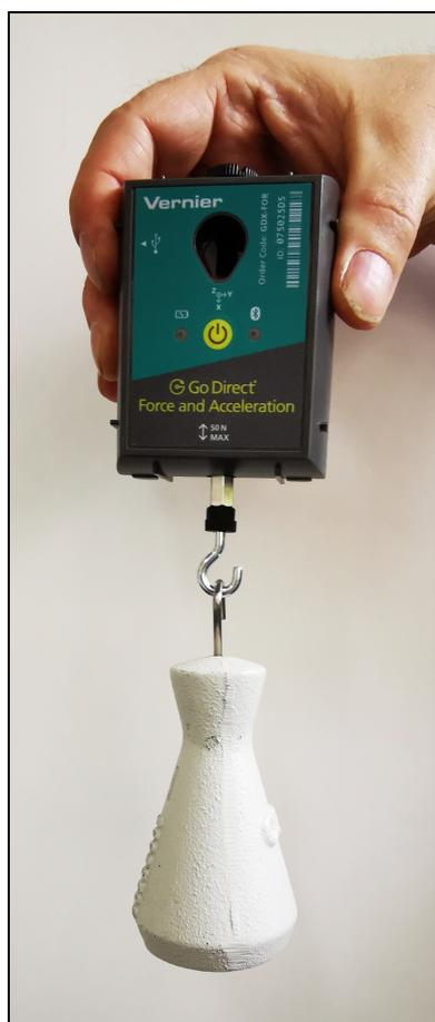
**Versuch mit integriertem Kraft- und Beschleunigungssensor**
